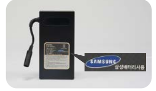
삼성배터리 (DC10,8V 7,500mAh)
